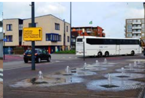
Jatos de água são acionados a 6 metros de altura quando veículos excedem os 30 km/h
